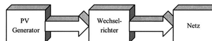
In ihrem grundsätzlichen Aufbau bestehen die netzgekoppelten Photovoltaik-Anlagen aus den Generatoren, die die Sonneneinstrahlung in Energie umwandeln, aus dem Wechselrichter, der den Gleichstrom in Wechselstrom wandelt und aus einem Zähler, der die Menge des eingespeisten Stroms ins Netz misst.
