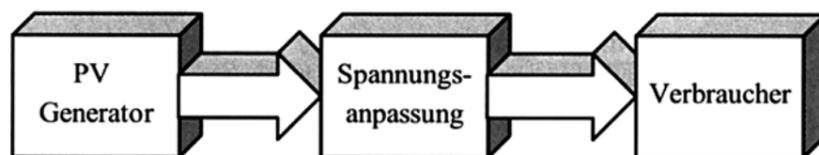
Bei Geräten, die auch bei Dunkelheit, also wenn kein Strahlungsangebot vorhanden ist, funktionieren müssen, wie etwa eine Armbanduhr, wird diese Zeit per Kondensatoren oder Akkumulatoren als Energiespeicher überbrückt. Bei Großgeräten bzw. großen Photovoltaik-Anlagen werden als Speicher, je nach benötigter Leistung einzeln oder im Verbund, heutzutage meist Blei-Säure-Akkumulatoren eingesetzt.<sup>24</sup>
