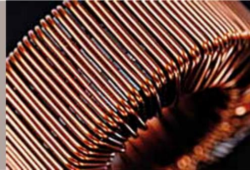
Drosseln werden in unterschiedlichen Ausführungen in Wechselrichtern verbaut, wobei man Filter- und Speicherdrosseln nur bei bestimmten Herstellern findet, da sie einer besonderen Anpassung bedürfen. Sie dienen zumeist der Funkentstörung oder Strombegrenzung. Man findet sie daher auch in fast allen elektrischen Geräten.
