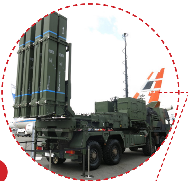
Abb. 24: IRIS-T SLM-Starter auf Basis eines MAN SX45 8x8 10 t.
